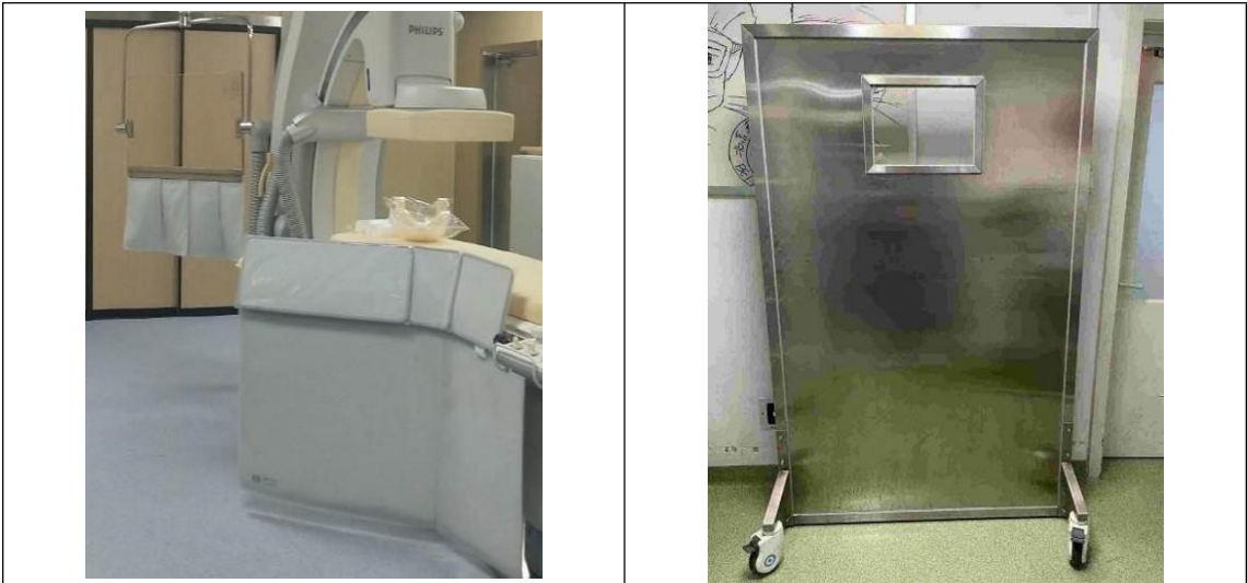
操作部位局部屏蔽防护设施
