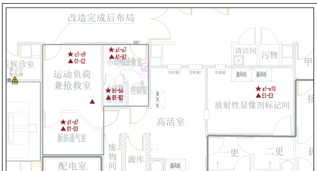
图 12-1 本项目建成后相关场所自行检测点位示意图 (标注★为剂量率检测点位, ▲为表面污染水平检测点位)
